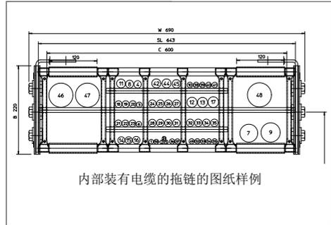
内部装有电缆的拖链的图纸样例
